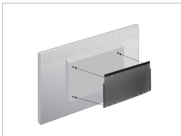
Abb. 2: Montage der VESA Platte
