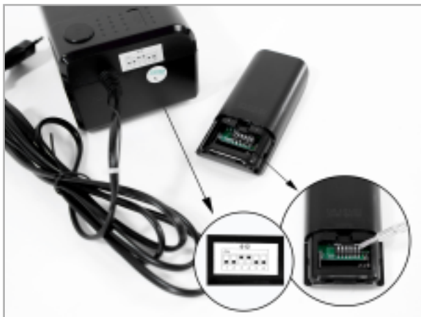
Abb. 4: Konfiguration der Fernbedienung nach Schaltbild
