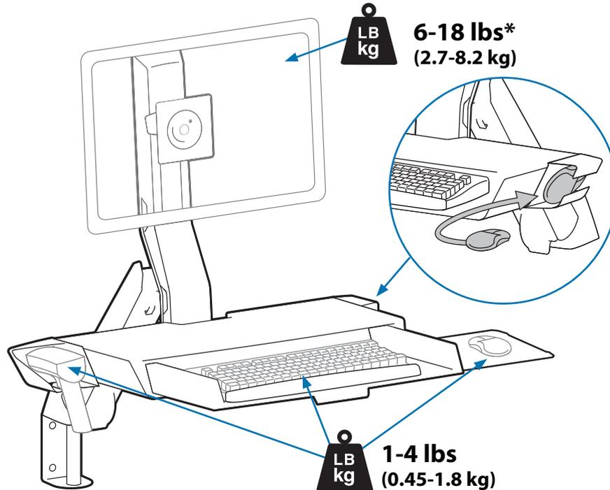
\* Der Combo Arm kann so angepasst werden, dass er Bildschirme mit einem Gewicht von bis zu 11,3 kg (25 lbs) unterstützt. In diesem Fall stehen die Optionen zum Heben und Neigen des Bildschirms jedoch nicht zur Verfügung. Weitere Informationen hierzu finden Sie auf Seite 7.
