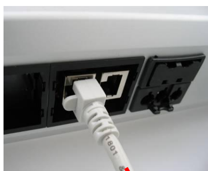
Anschluss zu Controller/Gerät oder weiterem Tastenfeld Connection to Controller / device or additional key button module
