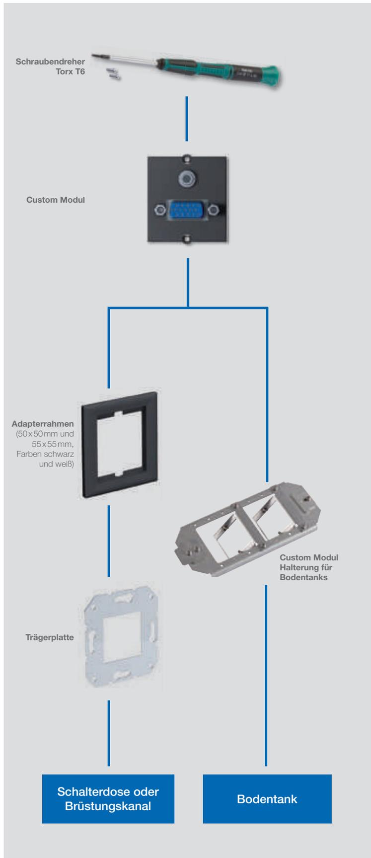
**Trägerplatte Custom Module für Schalterprogramm** | Edelstahl
