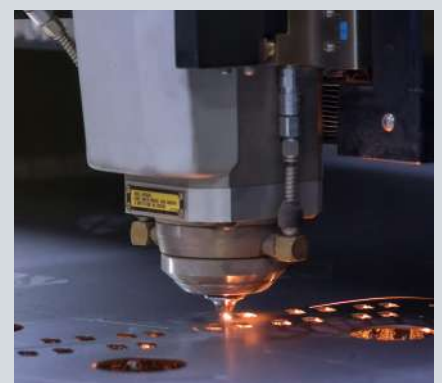
Laserschneiden für präzisionsgefertigte Muster und kurze Lieferzeiten
